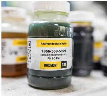
Le service d'analyse S•O•S<sup>SM</sup> de Toromont comprend une combinaison de tests tels que l'analyse des métaux, l'état de l'huile, la viscosité, la détection d'antigel et de carburant, la contamination de l'eau, les particules d'usure et d'autres contaminants internes et externes. Nous surveillons votre huile avec des méthodes développées par Caterpillar et conçues pour évaluer l'état des composants de votre machine, pas seulement l'état de votre huile.
